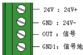
图1常温风量变送器接线图
